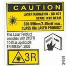
Lors de l'utilisation d'outils de mesure de la classe laser 3R, un zonage et un étiquetage clairs de la zone d'utilisation du laser sont nécessaires. Le zonage signifie que les personnes non autorisées ne peuvent pas accéder à la zone laser sans surveillance. Par conséquent, Hilti fournit un panneau d'avertissement laser correspondant pour marquer l'entrée du site.
