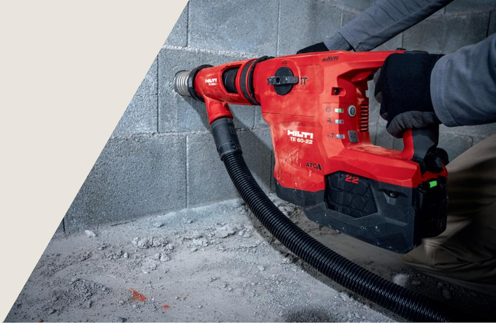
Les outils d'aujourd'hui sont puissants. C'est excellent pour la productivité, mais lorsqu'une mèche frappe un obstacle, des blessures peuvent se produire si la perceuse tourne de façon incontrôlable. Dans la mesure du possible, choisir des outils dotés de caractéristiques de sécurité intégrées qui aident à garder les équipes en sécurité et minimisent les risques de blessures.
