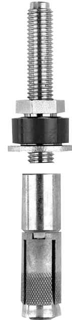
Cheville HSL-I M12 65/80 conçue pour une profondeur d'ancrage de 65 mm
