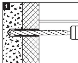
1. Percer un trou de 5/16 po dans le support à travers l'isolant.
