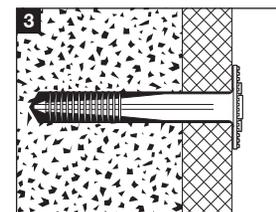
3. Le clou est posé. Pour les applications à l'extérieur, la tête du clou doit être recouverte par le matériau de finition.
