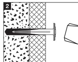
2. Enfoncer le clou au marteau jusqu'à ce que la rondelle affleure l'isolant.
