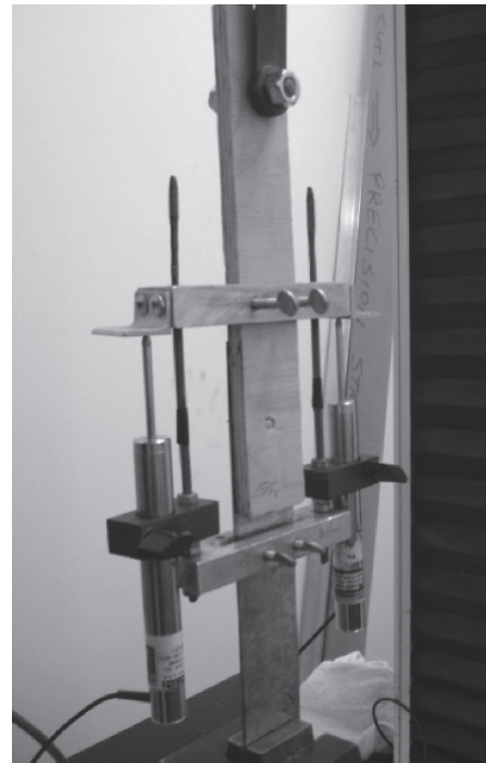
Figure 5 : Essais portant sur la résistance latérale (cisaillement) de petits éléments
