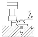
$h_{NVS} = 0,28$  po à 0,41 po (7,0 mm à 10,5 mm)
