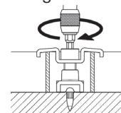
Ne pas trop serrer : L'étrier du fixateur ne doit pas plier.
